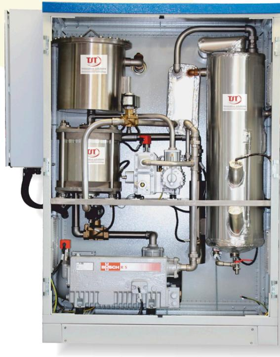
**Die Kraftstoffrückgewinnungsanlage VARECO® VENT/TSMF (Stage I und II)** ist eine 2 stufige Kompaktanlage mit Aktivkohle und Membrantechnologie.
