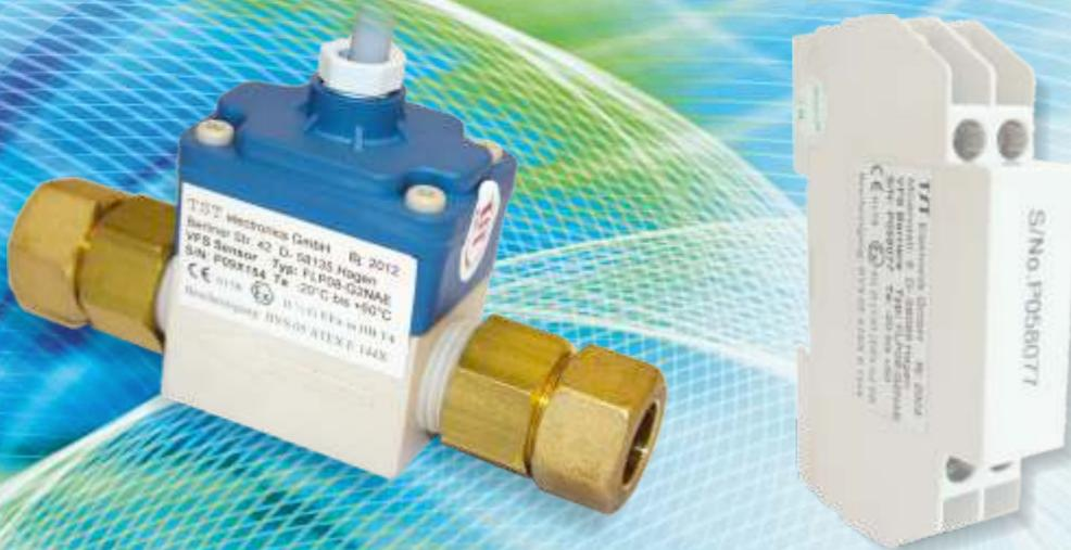
Der Vortex Flow Sensor „VFS“ arbeitet nach dem Karman'schen Phänomen der Wirbelablösung. Dieses Messprinzip beruht darauf, dass an einem stabförmigen Hindernis in einer Strömung Wirbel abgelöst werden, wobei die Wirbel-Ablösefrequenz ein Maß für die Strömungsgeschwindigkeit ist.
